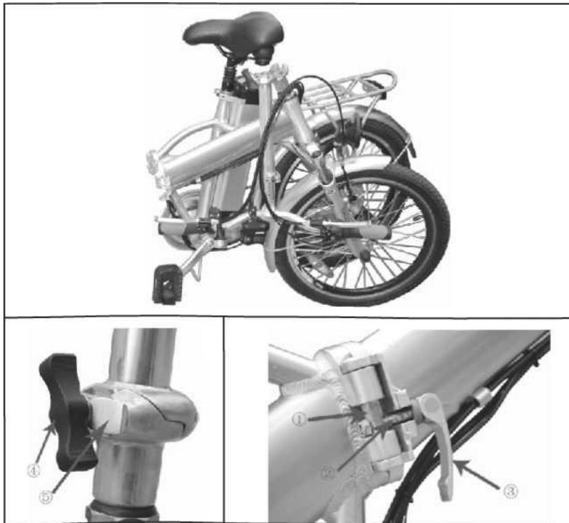
1 Tappi 2 Lukituspultti 3 Kiinnityskahva 4 Siipimutteri 5 Kiinnike
