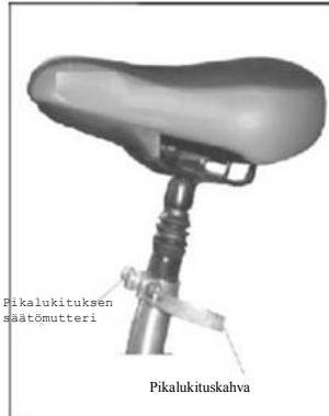
2. Väännä säätömutteria myötäpäivään niin, että kiristin on kiinni satulaputkessa. Väännä mutteria sitten kierroksen tai puoli kierrostaa takaisin päin ja paina vapautuskahva asentoon CLOSE (katso kuva).
